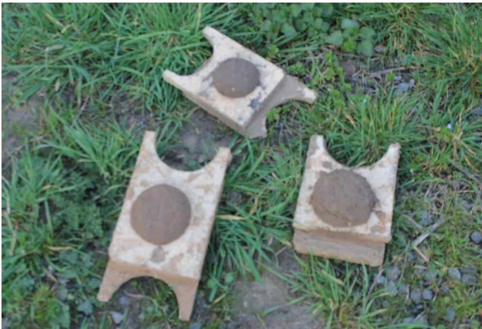
Le test le plus convaincant est celui avec le plus de pourcentage d'argile pure, c'est donc celui que l'on utilisera tout au long de la construction.
